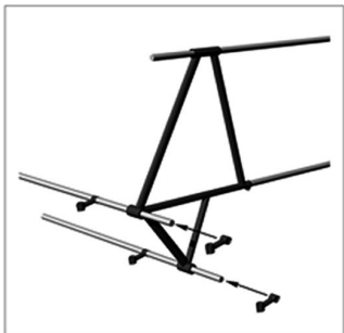
PRINCIPE D'ASSEMBLAGE ET DE SERRAGE DES ELEMENTS
