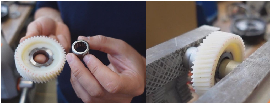
Figure 11 L'embrayage unidirectionnel et la méthode de démontage
