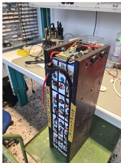
Figure 4 Modèle 3D du pack batterie avant réalisation et prototype réalisé
