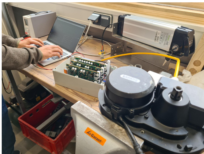
Figure 12 Setup de test pour l'onduleur et le moteur pédalier durant l'atelier d'intégration a Erlangen
